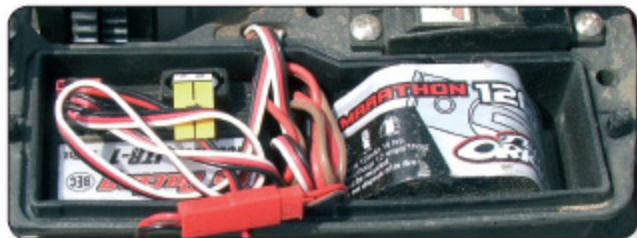
Il pacco batterie da 5 celle ci sta comodo, volendo ve lo consigliamo per poter dare un poco di potenza in più ai servi!
