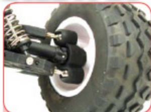
Sterzo su pivot ball e caster regolabile
